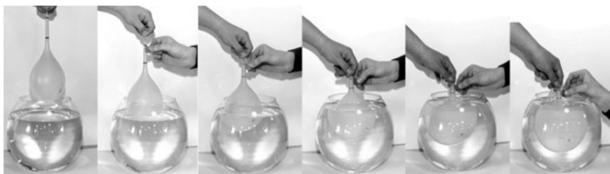
Слика 1. Демонстрација деловања силе потиска помоћу балона са водом
