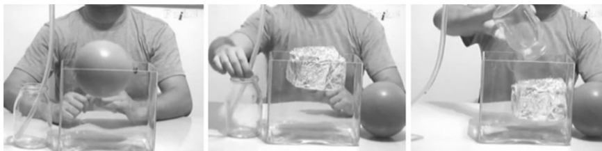
Слика 2. Понашање балона и „чамца” од алуминијумске фолије у гасу чија је густина већа од густине ваздуха – снимак „SF6 Denser than air” ( www.fizik.si )
